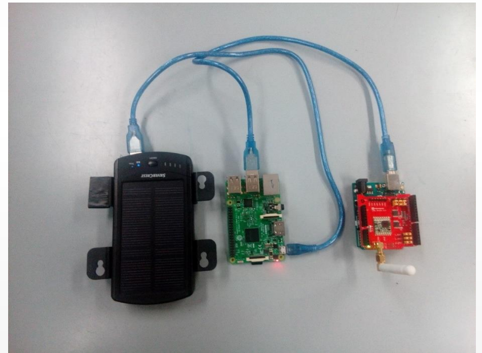
Εξοπλισμός εργαστηρίου Ρομποτικών Εφαρμογών ΓΠΑ με Power Bank, Raspberry Pi και Arduino Uno με Lora Dragino Shield
